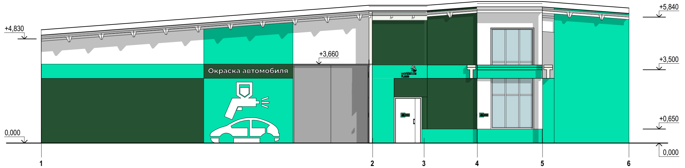
Развертка стен мастерской окраски автомобиля (1:100)
